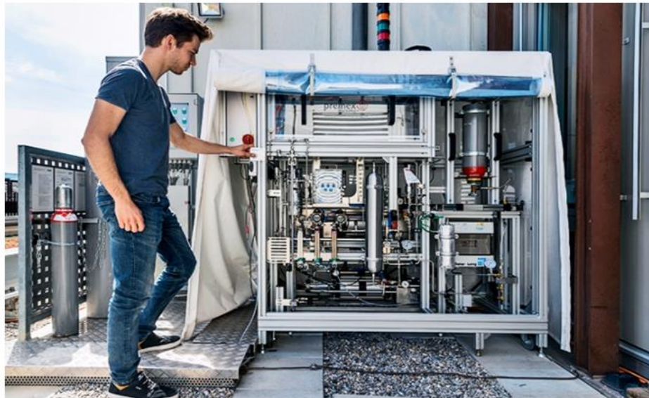
Рисунок 6. Экспериментальная система получения «из воздуха» углеродно-нейтрального моторного топлива Швейцарской высшей технической школы Цюриха
