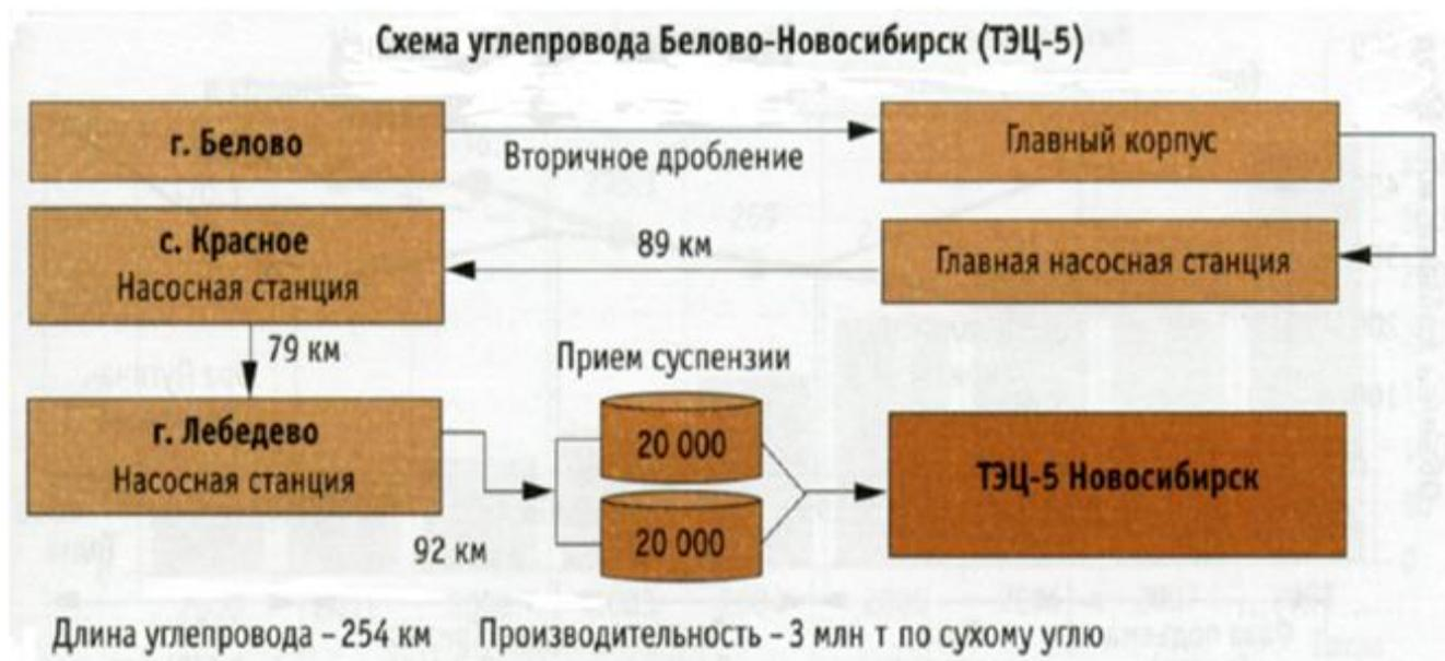
Рисунок 4 - Схема опытно-промышленного трубопроводного комплекса транспортировки водоугольного топлива (углепровода)
